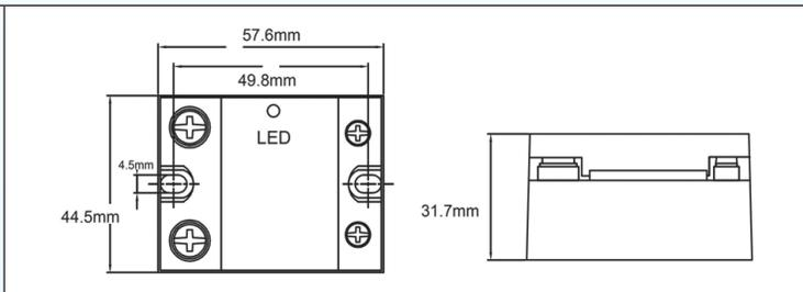
**Abmessungen:** 58 x 45,5 x 30,5mm
