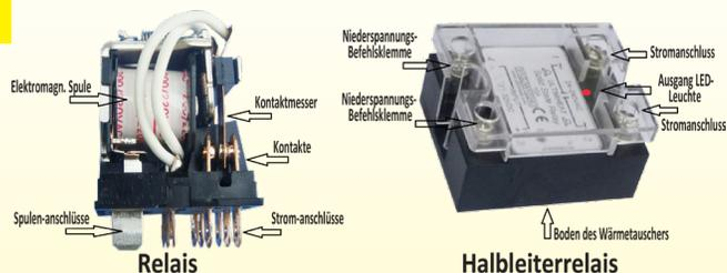
**Das Relais oder elektromechanische Schütz:** Die Spule besteht aus einer sehr großen Anzahl von Windungen eines sehr dünnen Kupferdrahtes. Wenn ein ausreichender Strom durch die Spule fließt, erzeugt sie ein Magnetfeld, das den beweglichen Teil anzieht und die Zungen mit den elektrischen Kontakten bewegt. Fließt der Strom in der Spule nicht mehr, kehren die Kontakte dank einer Rückstellfeder in ihre Ausgangslage zurück.
