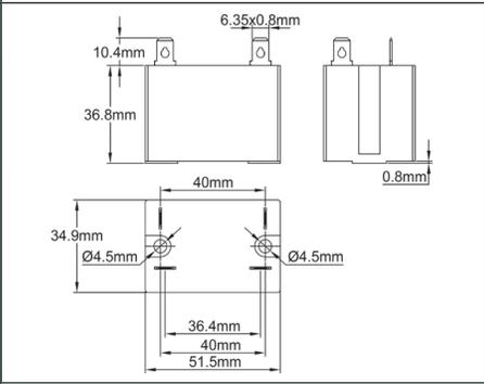
1 x 30A 250V ohmsch (AC1) (CE und UL) Schließer, versiegeltes Gehäuse, 6,35 x 0,8 Klemmen. Dieses Relais kann ohne Montageplatte direkt auf alle aus Kunststoff ausgelösten Fronten montiert werden, die für Kolben- und Kapillarthmostate und Elektronische Regler vorgesehen sind, sowie auf die flachen Fronten der Verteilerkästen in diesem Katalog. Spule 200-240V AC.
