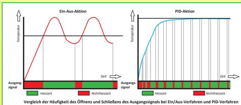
Die PID-Regelung kann zwar die Regelung in einer Reihe von Konfigurationen verbessern, hat aber den Nachteil, dass das Ausgangssignal sehr schnell zyklisch wird, was die Lebensdauer der Leistungsrelais stark verkürzt und in den meisten Fällen den Einsatz von Halbleiterrelais erfordert.
