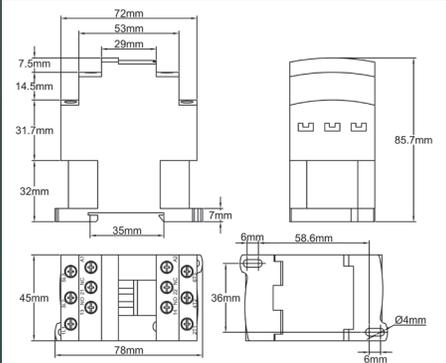
3 x 25A oder 3 x 32A 250/400V AC ohmsch (AC1), Schraubklemmen, 240V AC oder 400V AC Spule. Entspricht der Norm IEC947-1 (EN60947-1), aber die große Grundfläche schränkt seine Anwendungen in Regelkästen ein. Es passt nicht in die Y8 Typen, kann aber in Y6 und Y7 mit 1-poligem Thermostat verwendet werden.
