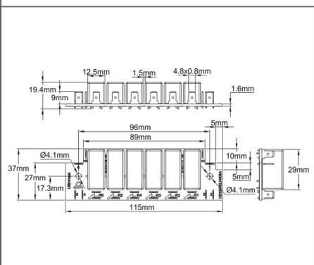
Elektronische Relais-Platine, 6 Relais 16A 250V. Sie sind in 4 bis 6 Relais erhältlich, Schließer. Die Relais-Spulen werden einzeln gespeist, 220-240V. 4,8 x 0,8 Klemmen. Sie können direkt auf allen erweiterten Thermostat-Montageplatten aus Kunststoff, auf den Platten der elektronischen Regler und auf den flachen Kunststoff-Verteilerkästen installiert werden. Mit Steckbrücken können Relais-Spulen für den gleichzeitigen Betrieb zusammengeschaltet werden.
