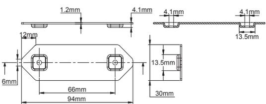
Für Nebeneinandermontage eines Kastens mit wettergeschütztem Lüfter auf einem anderen Kasten mit den gleichen Abmessungen.
