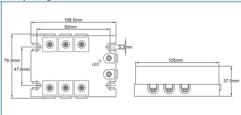
**Abmessungen:** 108,5 x 76,3 x 37,5mm
